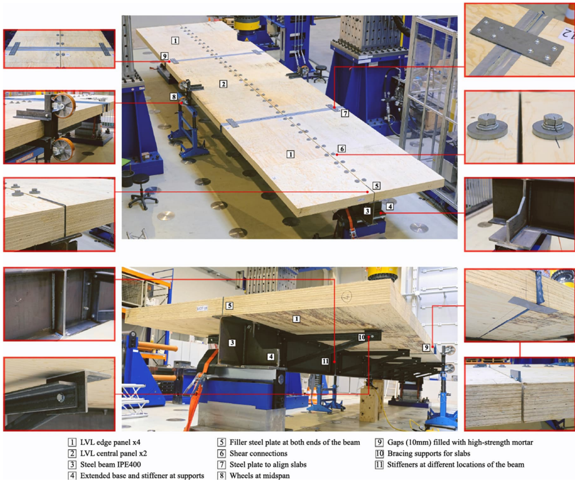
Kuva. 4.33 STC-palkkinäytteiden komponentit [49]
