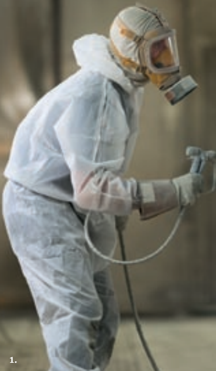
Kuva 1: Teräsrakenteita pintakäsitellään usein sekä osina että loppukokoonpanon jälkeen.
