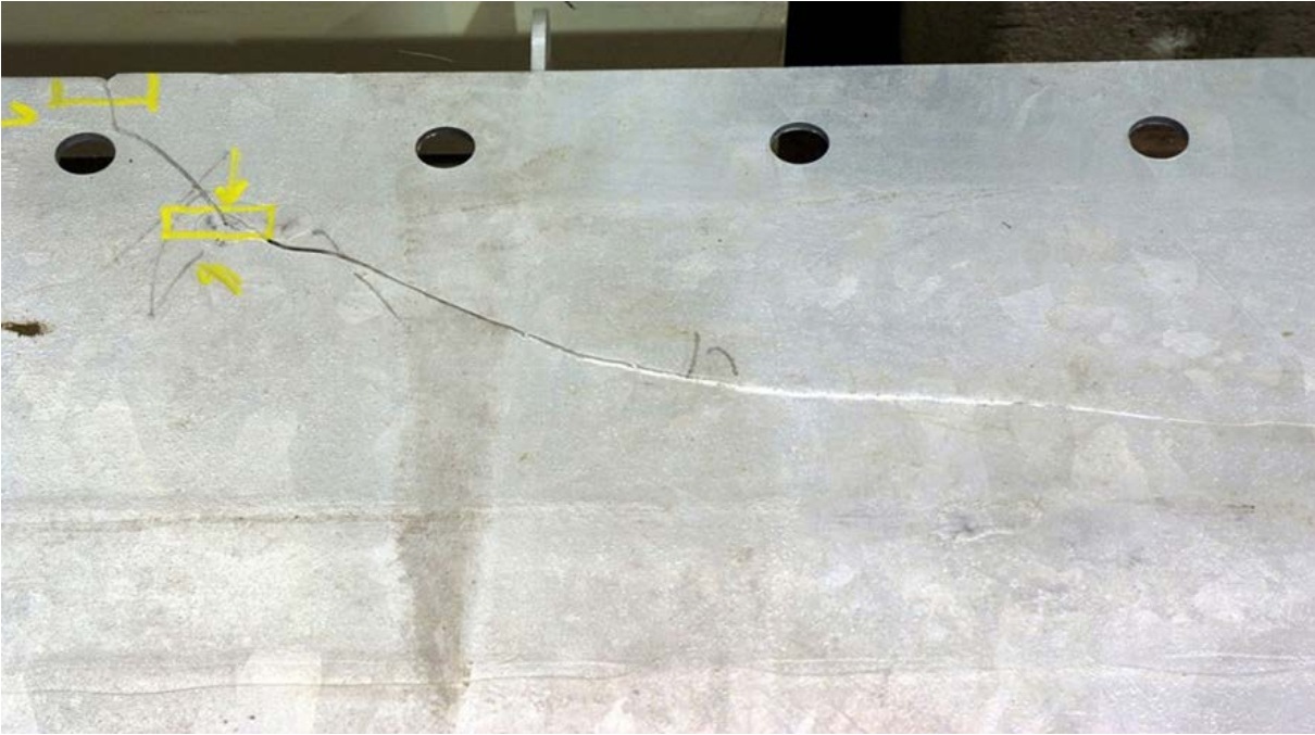
Terävissä leikkauspinnassa olevasta lovesta alkanut halkeama
