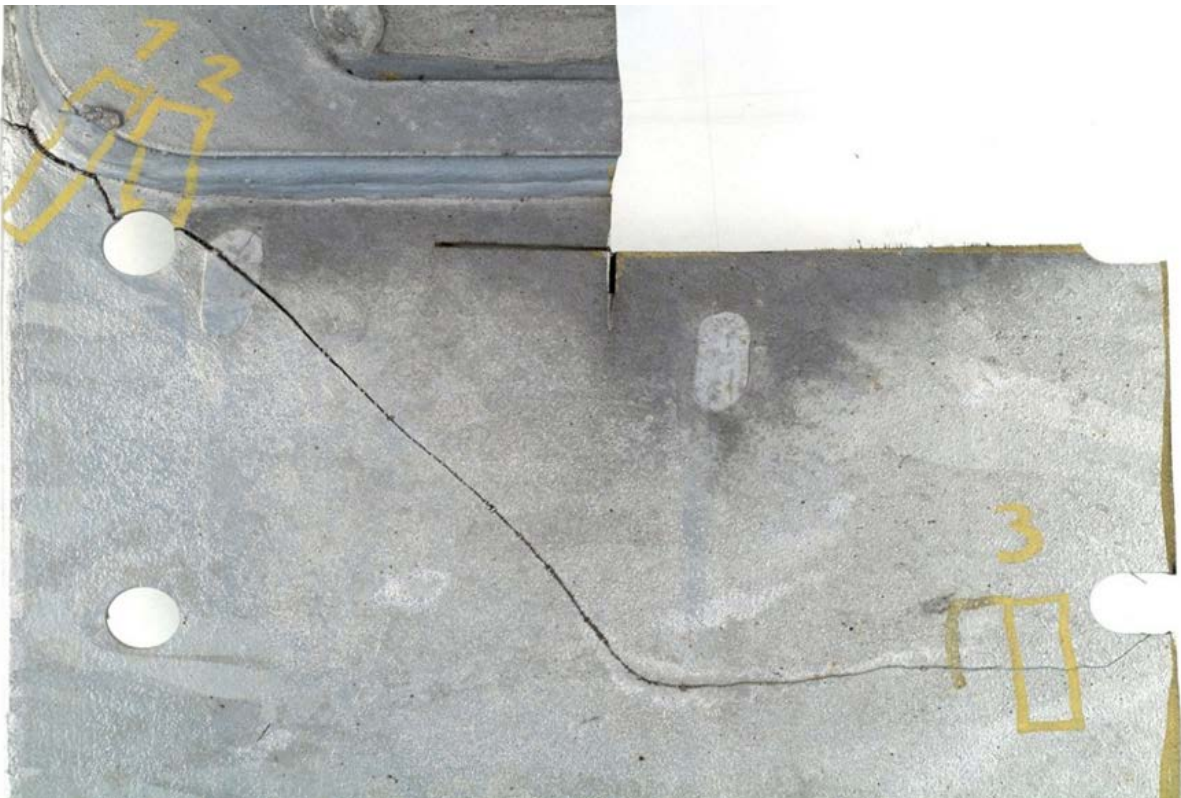
Hitsin muodon ja reiän terävän leikkauspinnan aiheuttama halkeama
